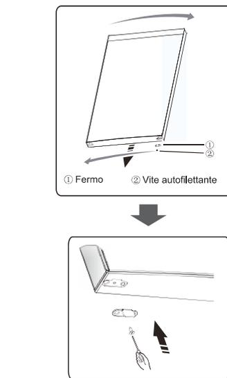
7. Cambiare le coperture dei fori sulla piastra di copertura da sinistra a destra (come mostrato nella figura sottostante).
