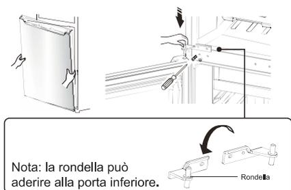
12. Svitare l'asse della cerniera superiore, capovolgere la cerniera superiore e fissare l'asse su di essa. Poi metterla sul lato per usarla.
