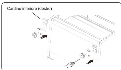
11. Spostare lo sportello inferiore e regolare la posizione per allineare il sito del foro inferiore con l'asse della cerniera superiore. Ruotare la cerniera centrale di 180 gradi, spostare la rondella sull'asse verso il lato superiore, regolare la cerniera centrale nella posizione appropriata e poi installarla.
