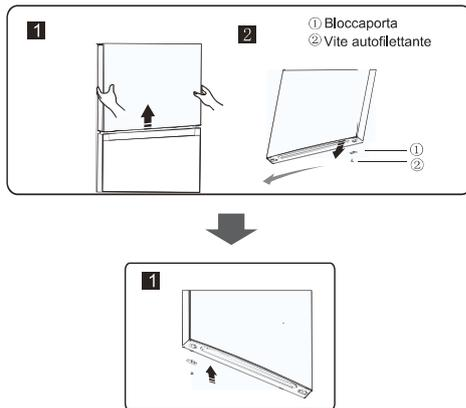
5. Allentare le viti per fissare la cerniera centrale e rimuovere la cerniera centrale. Quindi rimuovere la porta inferiore.
