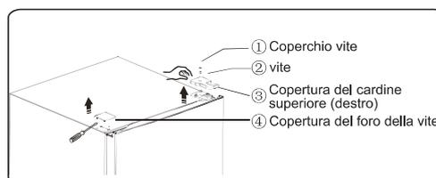
3. Svitare le viti della flangia (1) che servono per il fissaggio della parte superiore destra della cerniera (2). Sollevare lo sportello superiore e posizionarlo su una superficie imbottita per evitare che si graffi.
