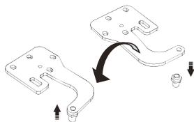
13. E' sufficiente rimontare tutto come al punto 2, spostare la cover della cerniera superiore (3) a sinistra e fissarla con le viti (2) e poi installare la cover della vite (1). Infine, spostare la cover del foro della vite (4) a destra.
